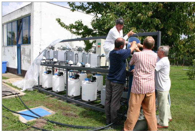
10. kép. A félüzemi arzénmentesítő kísérleti berendezés beüzemelése (Fotó: Laky Dóra) Photo 10. Preparation for starting the arsenic removal pilot scale experiments (Photo by Dóra Laky)
