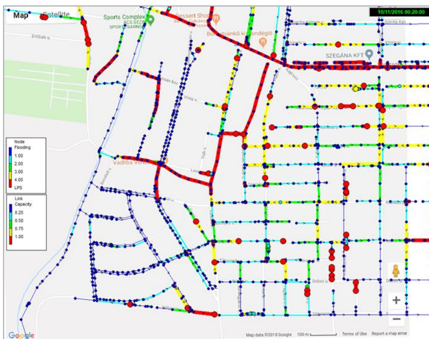
8. ábra. Felszíni elöntések és csatorna kapacitások kihasználtsága (Fülöp és társai 2018) Figure 8. Surface flooding and capacity of sewers (Fülöp et al. 2018)
