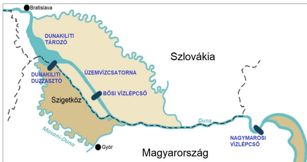
7. ábra. A Bős-Nagymarosi Vízlépcsőrendszer eredeti elrendezése Figure 7. The original layout of the Gabčíkovo-Nagymaros Barrage Scheme
