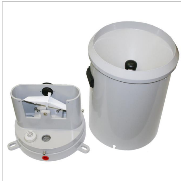
2. ábra. Egy hagyományos kialakítású billenőkanalas csapadékmérő berendezés a szerkezet burkolatának és tölcserének eltávolításával
