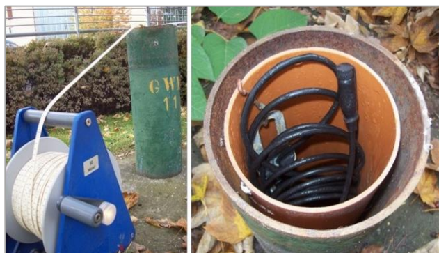
1. ábra. Fényjelzős vízszintmérő műszer (balra); Folyamatos talajvízszint rögzítő készülék (Dataqua) (jobbra) Figure 1. Water level meter with light bulb (left); Continuous water level recorder in well (right)
