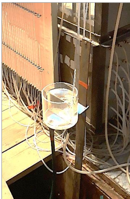
2. kép. Az alsó peremként szolgáló körbukó Photo 2. Round weir to serve as lower boundary
