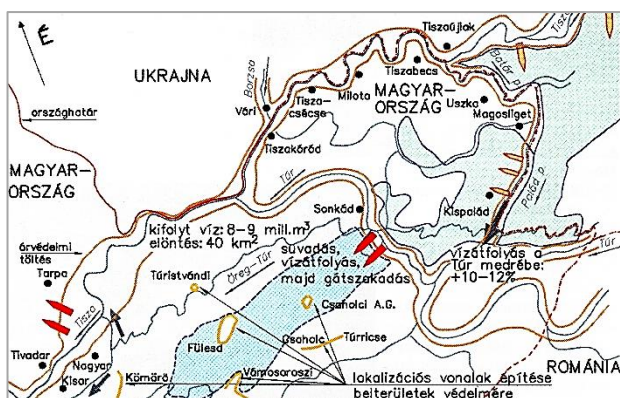
10. ábra. Vízátfolyás Ukrajnából a Palád-patakon keresztül és a Túr balpart 12+000 és 12+400 tkm szelvényében suvadásból kifejlődő szakadások
