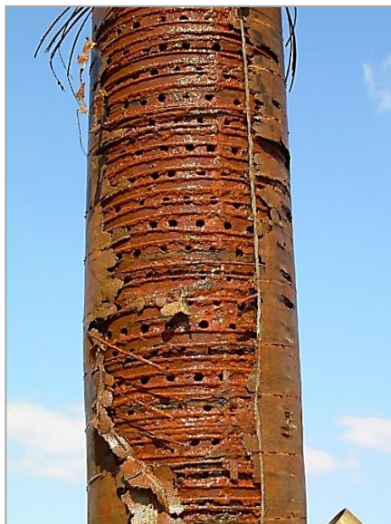
7. kép. Vas-oxid bevonat a kútból kiépített szűrőrakaton (Forrás: BÁCSVÍZ Zrt.) Photo 7. Iron oxide coating on removed filtered well (Source: BÁCSVÍZ Zrt.)
