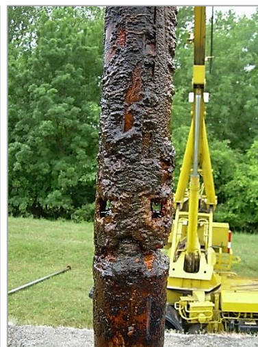
8. és 9. kép. Vas- és mangán-oxid csapadék a kútból kiépített búvárszivattyún (Forrás: BÁCSVÍZ Zrt.) Photo 8 and 9. Iron and manganese oxide precipitation on a submersible pump removed from a well (Source: BÁCSVÍZ Zrt.)
