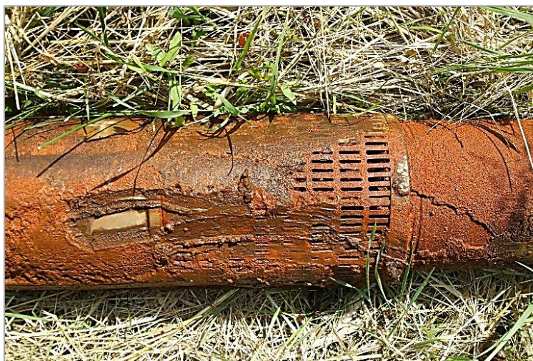
8. és 9. kép. Vas- és mangán-oxid csapadék a kútból kiépített búvárszivattyún (Forrás: BÁCSVÍZ Zrt.) Photo 8 and 9. Iron and manganese oxide precipitation on a submersible pump removed from a well (Source: BÁCSVÍZ Zrt.)
