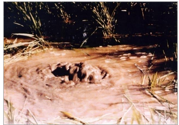
2. kép. A nyomás alatt feltörő buzgár bugvogása Photo 2. Sand boil bubbling under pressure
