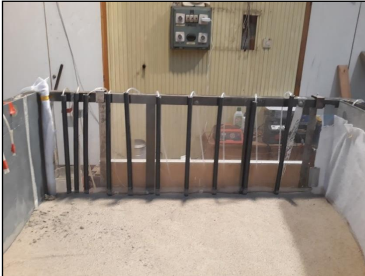
1. kép. A közepes homokmintával feltöltött modell a megfigyelő kutakkal Photo 1. Sandbox model with medium sand sample with observation wells
