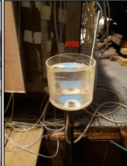
2. kép. Az alsó peremként szolgáló körbukó Photo 2. Weir for control the pumping well
