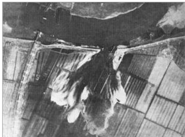
3. kép. Az Overslag-i kopolya (hollandul kolk) Betuweben, ember indukálta gátszakadás a második világháború alatt
