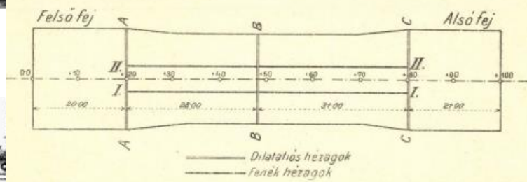
A soroksári kamarazsilip dilatációs és fenékhézagainak elrendezése.
