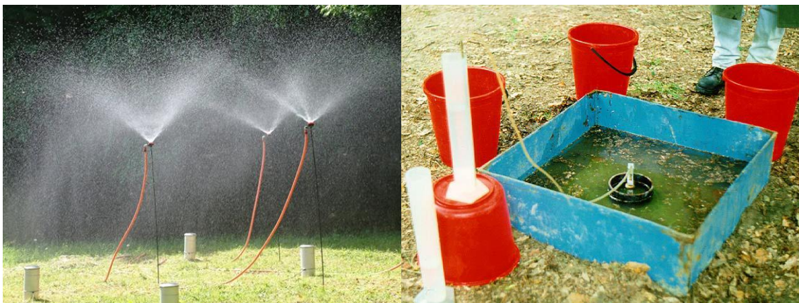
1. ábra: beszivárgás-mérés kísérleti parcellán és Müntz-Laine készülékkel
