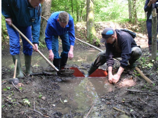
2. ábra: hordozható mérőbukó telepítése
