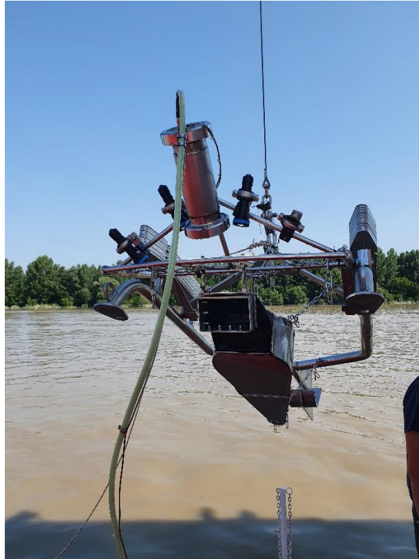
8. fénykép: A mérések során használt BfG-típusú görgetett hordalékfogó eszköz
