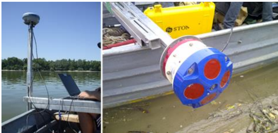
5. fénykép: Stonex RTK GPS (bal) és a WorkHorse Rio Grande 1200 kHz típusú ADCP (jobb)
