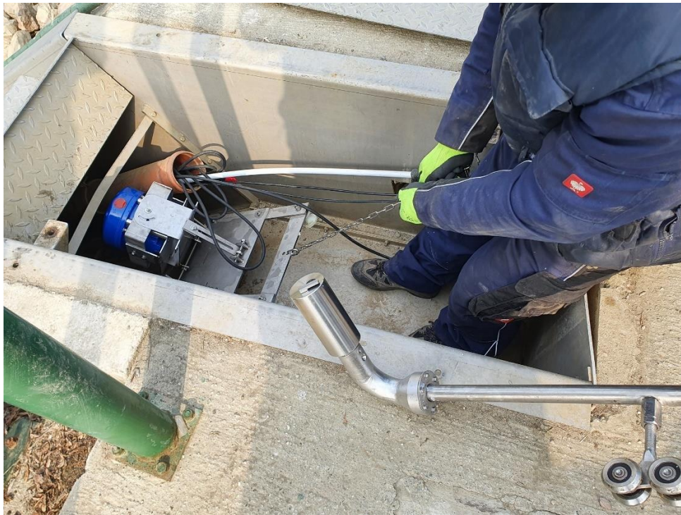
2. fénykép: A H-ADCP eszköz mozgatása a műszercsatornában. Előtérben a rudazatra erősített OBS látható.
