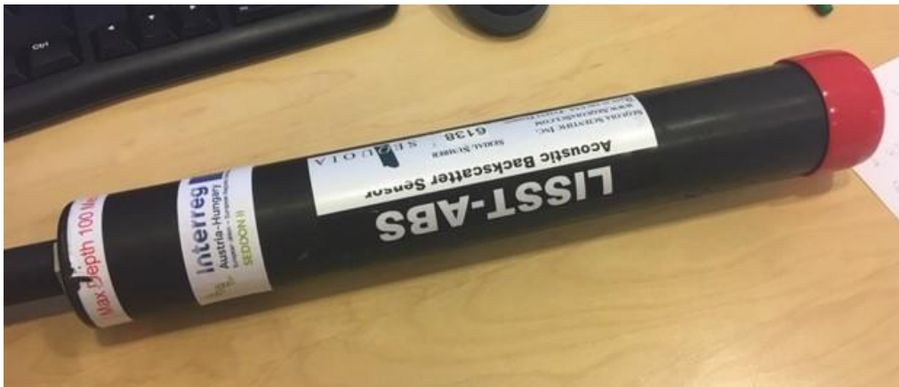
6. fénykép: A SEDDON II projekt keretében beszerzett LISST-ABS műszer
