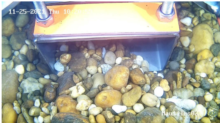
9. fénykép: Víz alatti kamera felvétele a görgetett hordalék beáramlásáról a mintavevő száján
