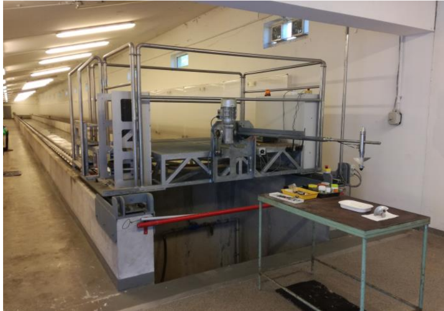
1. ábra Kalibrációs Labor és Vízsebességmérő Csatorna mérőberendezése
