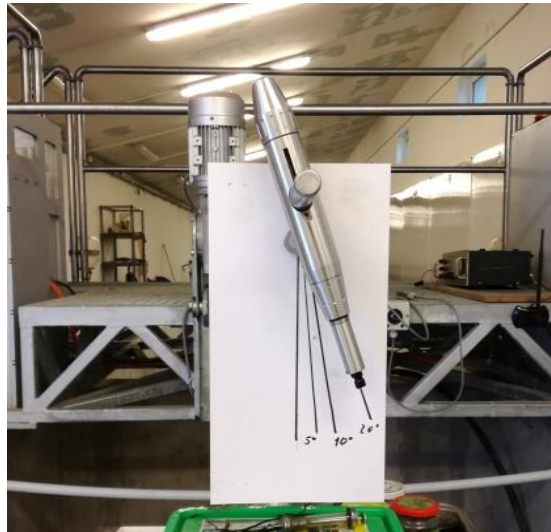
3. ábra Műszer szöghelyzetének beállítása
