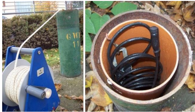
1. ábra. Fényjelzős vízszintmérő műszer (balra); Folyamatos talajvízszint rögzítő készülék (Dataqua) (jobbra)
