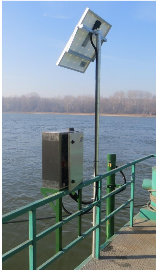
2. kép. Távjelzős zavarosságmérő állomás (Duna folyam, 1479,6 fkm, bal part, szerző fényképe)
