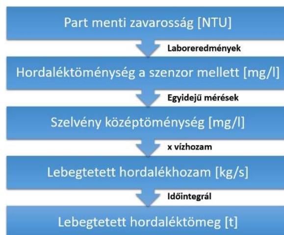
1. ábra. Lebegtetett hordalékhozam meghatározása zavarosság alapján ( Habersack és társai 2019b, szerző fordítása )
