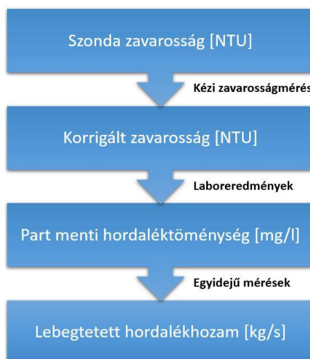
3. ábra. Lebegtetett hordalékhozam meghatározása zavarosság alapján – az alkalmazott módszer
