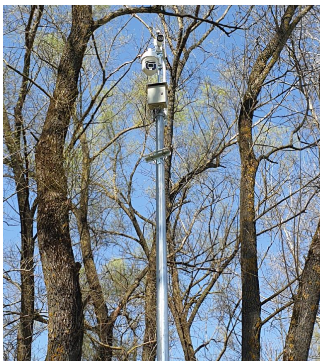
11. ábra. Hőkamera a Tisza folyó tiszabecsi hullámterében
