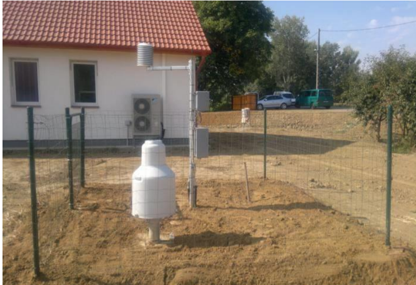
3. ábra. Súlyméréses elven működő csapadékmérő (Pluvió) távmérő állomás – Lónya
