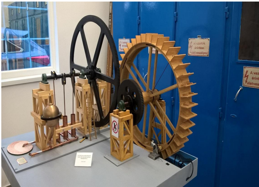
A Tummler -féle vízemelő szerkezet modellje a veszprémi Víziközmű Múzeumban
