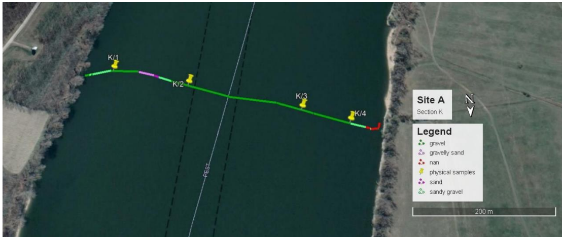
3. ábra. A mérőhajó útvonala egy példa szelvényben, beszínezve a szemrevételezés alapján jellemző mederanyag frakció szakaszokkal. A bal part a kép bal oldalán látható. A sárga jelölők a mintavételi pontokat jelölik.
