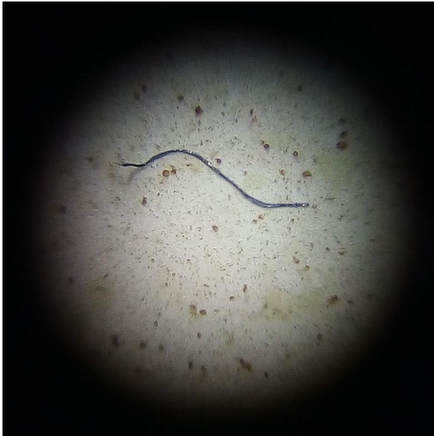
6. ábra Mikroszkóp kép Sugovica 3. minta mikroműanyag részecske (saját kép és szerkesztés)
