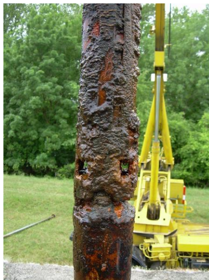
8. és 9. kép: Vas- és mangán-oxid csapadék a kútból kiépített búvárszivattyún (BÁCSVÍZ Zrt., 2009 és 2015)
