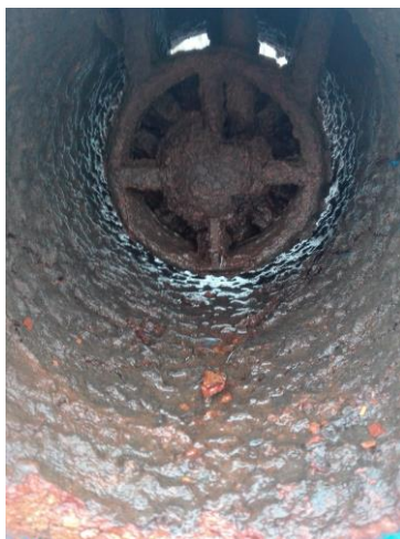
10. kép: Partí szűrésű vízműkútból kiépített szerelvény vas- és magán csapadékkal borított belső felülete
