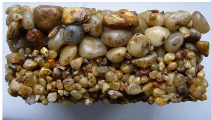
2. kép: A kavicsos vízáteresztő réteg (forrás: Pannon-Víz Zrt.)
