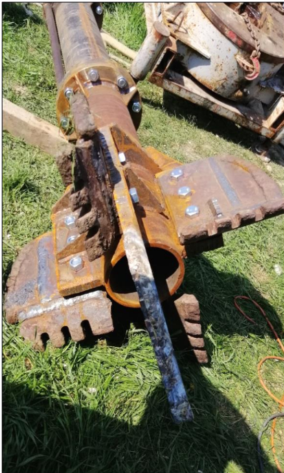
2. és 3. fénykép: Négyélű balöblítéses fúrófej és nagy átmérőjű fúrószerelvény külső levegővezetéssel
