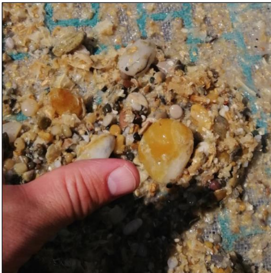
5. és 6. fénykép: A furadék átlagos, jellemző szemcseösszetétele és a fúrószerszámba szorult egyik nagyméretű görgeteg
