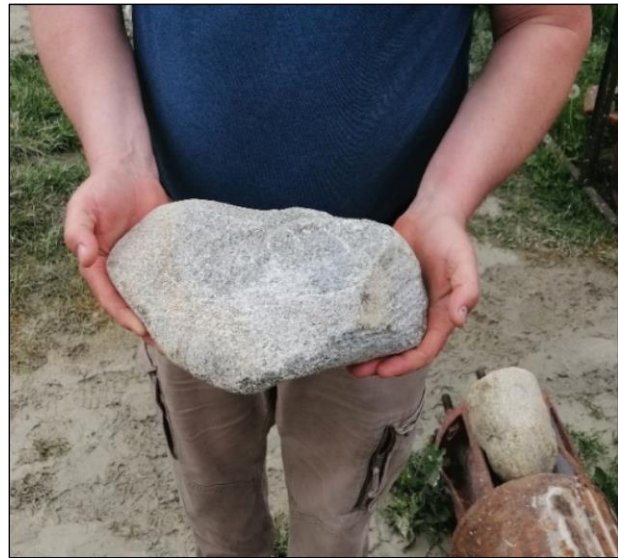
5. és 6. fénykép: A furadék átlagos, jellemző szemcseösszetétele és a fúrószerszámba szorult egyik nagyméretű görgeteg
