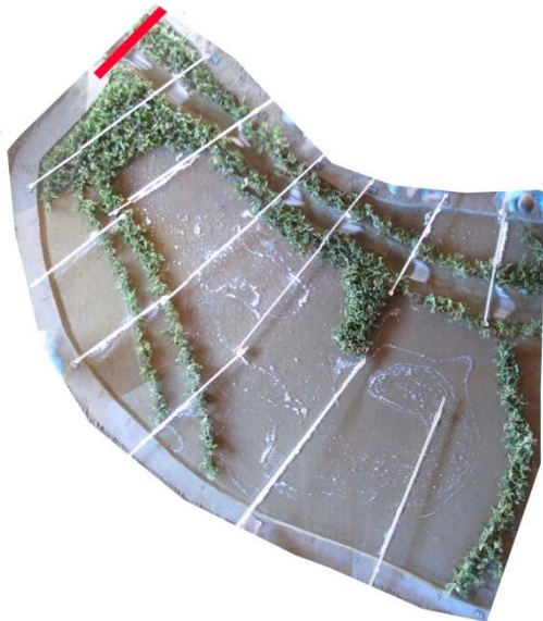
5 – 6 kép: Áramképek a jelenlegi állapot vizsgálata során
