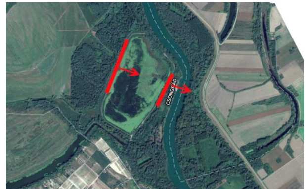
20 – 21 kép: A nyárigáton átbukó víz irányvektora a töltés felé mutat.
