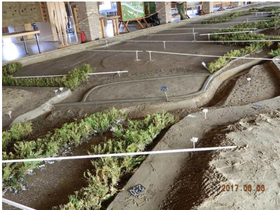
18 – 19 kép: Balra a körtöltés környezetének átalakítása, jobbra az ennek hatására kialakult áramkép
