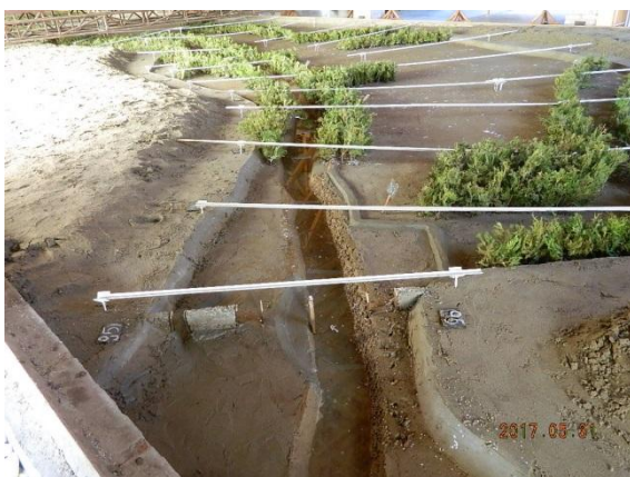
13 – 14 kép: A 2 változat kialakítása: balra a hídszelvény, jobbra a körtöltés környezete
