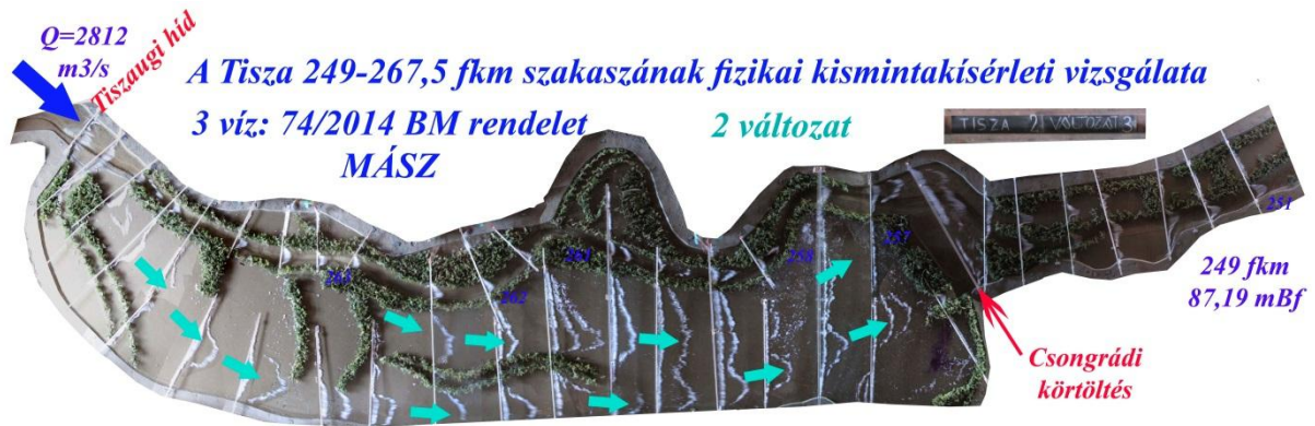
15 kép: Áramlási irányok alakulása a 2 változat beépítésének hatására
