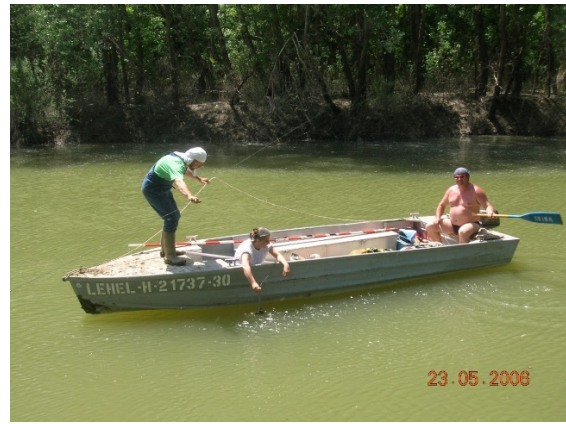
3.kép Szondázás és ultrahangos mérés csónakból
