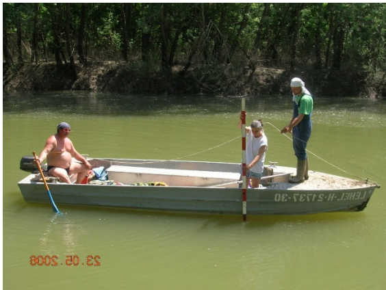
3.kép Szondázás és ultrahangos mérés csónakból
