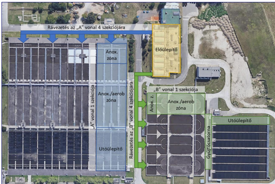
1. ábra. Az Észak-pesti Szennyvíztisztító Telep biológiai tisztítási fokozatának elrendezése
