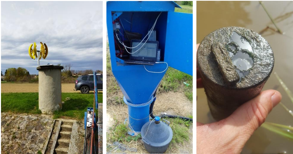
3. ábra. Törökkopányi mérőállomás energia ellátását biztosító szélgenerátor (balra), Szenzorok és a mintavevő vezérlőjének elhelyezése a Tamási vízmérce szekrényben (közép), SOLITAX t-line SC Turbidity szonda ablaktörővel
