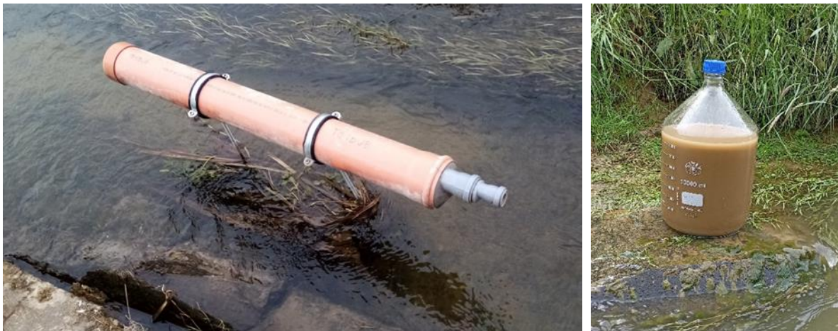
4. ábra. Philips mintagyűjtő a lebegőanyagok (SPM) egy adott vízszintet meghaladó időszak időben integrált mintázására (balra) és az eszközzel gyűjtött minta (jobbra)
