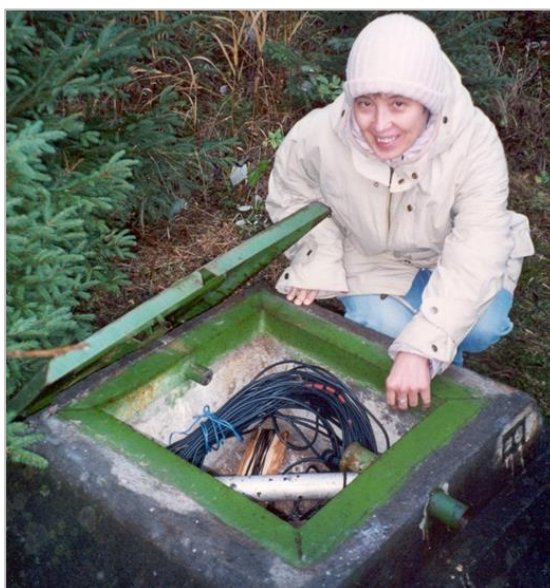
2a. ábra. DATAQUA mérőműszer a Garadna-forrásban; 2b. ábra. Az NV-17 karsztvízfigyelőkút kútfeje a DATAQUA és a kézi mérőeszközzel (Fotó: Lénárt László)
