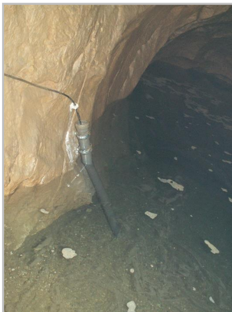
2e. ábra. Alul becsavarozott, felül a tolózárig belógatott DATAQUA mérőműszer termálkarsztkút kútfején (Fotó Lénárt László);
