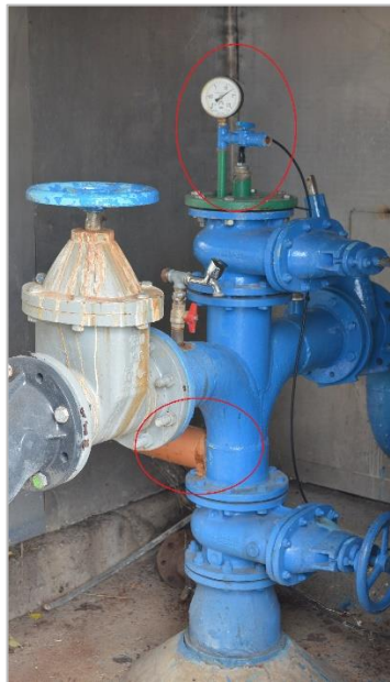
2e. ábra. Alul becsavarozott, felül a tolózárig belógatott DATAQUA mérőműszer termálkarsztkút kútfején (Fotó Lénárt László);
