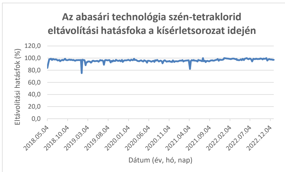
5. grafikon: Abasár vízkezelő technológia szén-tetraklorid eltávolítási hatásfoka a kísérletsorozat idején
