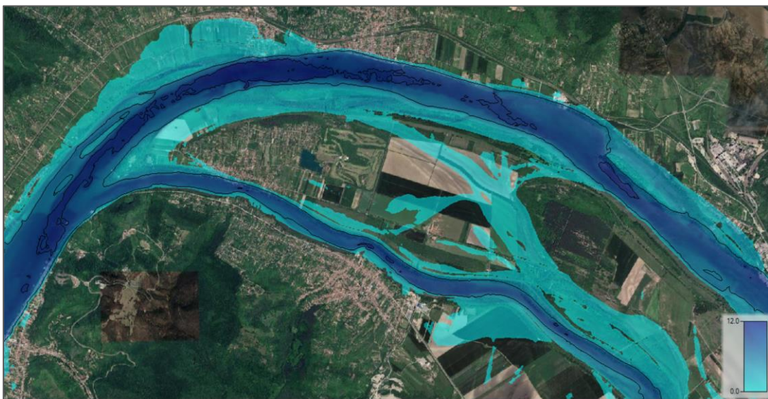
17. ábra HEC-RAS modelleredmény A II. fokú árvízvédelmi készültségi szinthez tartozó vízhozam esetén
