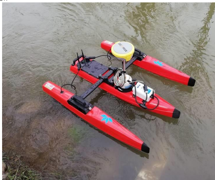
2. kép Teledyne Q-Boat 1250 drón, Sontek M9 ADCP-vel
