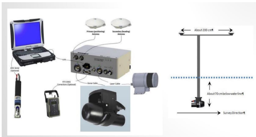
1. ábra Norbit iWBMS integrált multibeam mérőrendszer elemei
