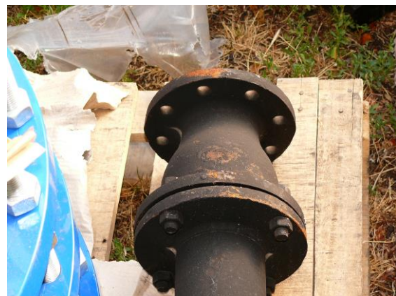
28. ábra. Beépítés előtt már korrodált idom
