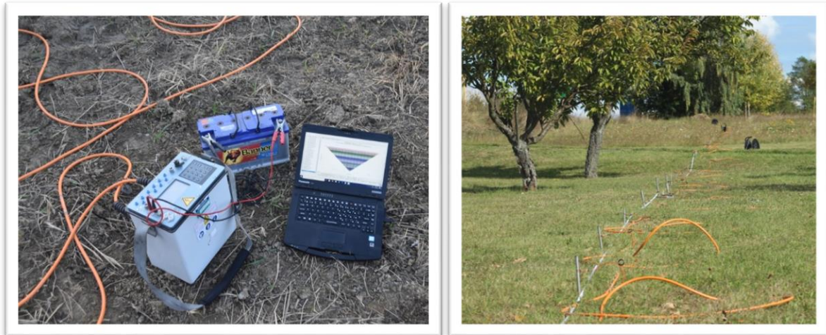
24. sz. képsorozat: Geoelektromos méréshez használt elektróda rendszer
